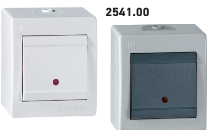
2541.00 2541.1A Sklopka jednopolna sa indikacijom 10AX/250V~ IP44 Single-pole switch with indication 10AX/250V~ IP44 • Indikacija svetli kada je strujno kolo otvoreno • Indication is on when the circuit is open
