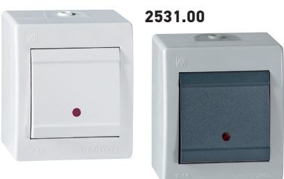
2531.00 2531.1A Sklopka naizmjenična sa indikacijom 10AX/250V~ IP44 Two-way switch with indication 10AX/250V~ IP44 • Indikacija svetli kada je strujno kolo otvoreno • Indication is on when the circuit is open
