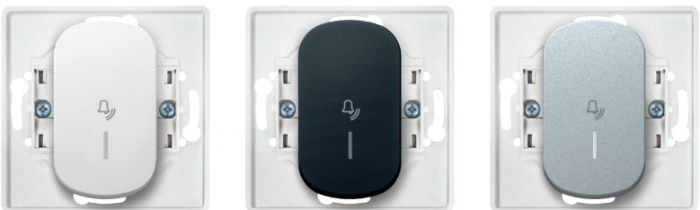
E610IU.x Taster sklopka za zvono sa indikacijom 10A/250V~ Bell push-button switch with indication 10A/250V~ • Indikacija svetli kada je sklopka isključena • Indication is on when the switch is off
