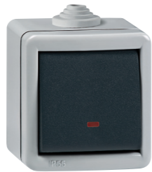
2831.1A Sklopka naizmjenična sa indikatorom 10AX/250V- Alternative switch with indication 10AX/250V- • Indikacija svetli kada je strujno kolo otvoreno • Indication turns on when the circuit is open
