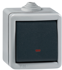
2811.1A Sklopka jednopolna sa indikatorom 10AX/250V- Single-pole switch with indication 10AX/250V- • Indikacija svetli kada je sklopka isključena • Indication turns on when the switch is off
