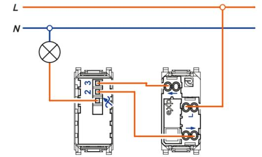
Elektronski regulator sa naizmjeničnom sklopkom, povezivanje u naizmjeničnom režimu rada
