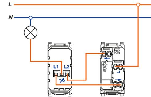
Elektronski regulator za induktivno opterećenje, povezivanje u naizmjeničnom režimu rada
